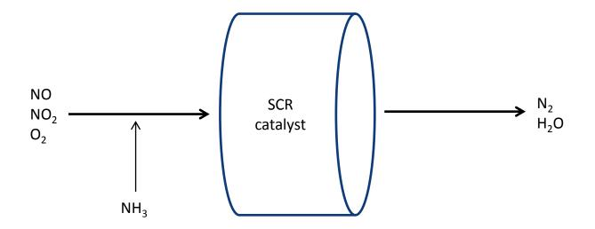
$4NH_3 + 4NO + O_2 \rightarrow 4N_2 + 6H_2O$   $4NH_3 + 2NO + 2NO_2 \rightarrow 4N_2 + 6H_2O$ Fast reaction  $4NH_3 + 3NO_2 \rightarrow \frac{7}{2}N_2 + 6H_2O$ Slow reaction
