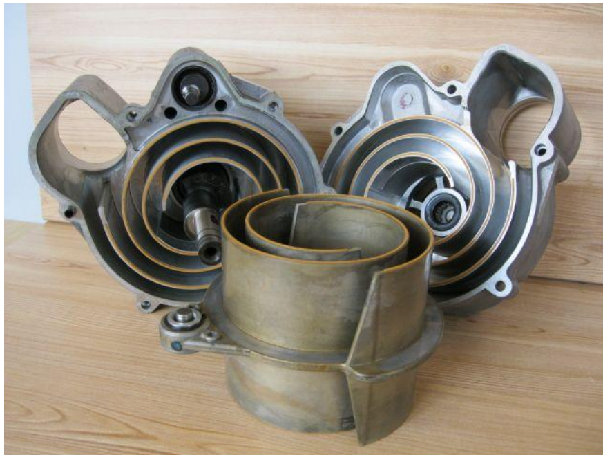
Fig. 5 En spiralkompressors inre beståndsdelar
