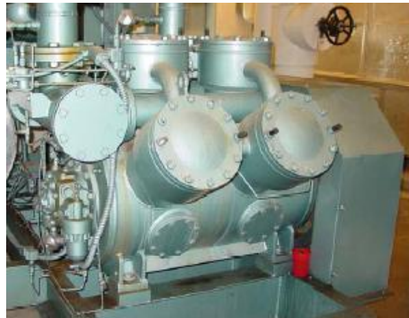
Fig.3 En verklig Kolvkompressor.
